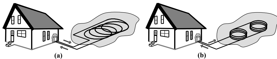
Fig. 5.2.63 Colector geotermal dispus în buclă imersată
