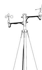
Fig. 5.2.27. Stâlp de măsurare a direcției și vitezei vântului
