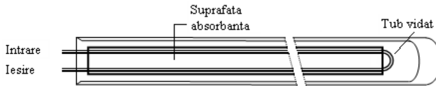
Fig 5.2.5 (a-b): Colectoare cu suprafață absorbantă cilindrică: (a) cu tub colector, (b) colectoarele sunt insertizate în placă
